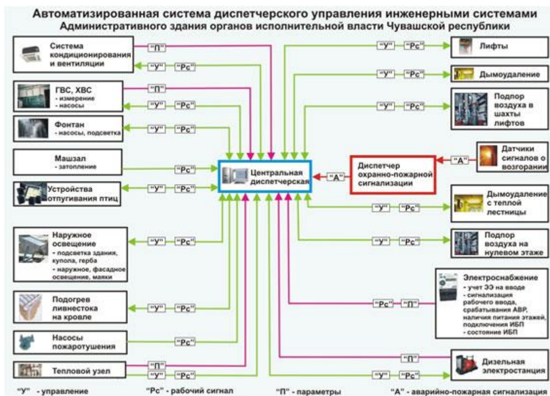
Пример структурной схемы диспетчеризации инженерных систем здания
